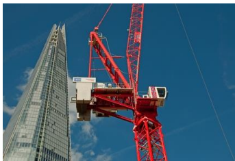
Ein WOLFF 700 B Wipper von HTC vor Londons Wahrzeichen The Shard auf der benachbarten Baustelle der London Bridge Station.
